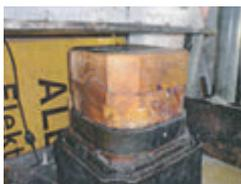
Pose de 4 plots en bois de 6 kg, une pressée dure 1h15. Presse hydraulique de 40 tonnes.
