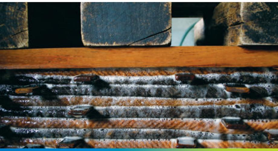
Les pommes sont broyées, puis emballées manuellement dans des toiles de fils de nylon posées les unes sur les autres, avant d'être pressées doucement.
